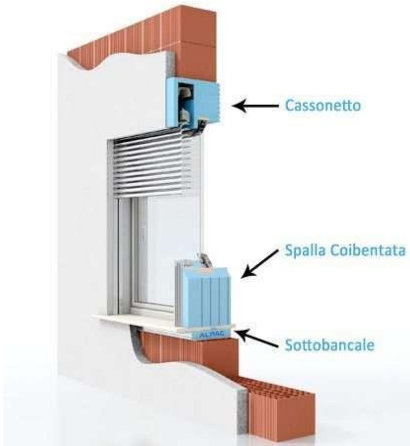
**Tutto il foro finestra/portafinestra sarà dotato di un monoblocco perimetrale a sostegno del serramento e con spallette isolanti in XPS denominato "SISTEMA "MONOBLOCCO".**
